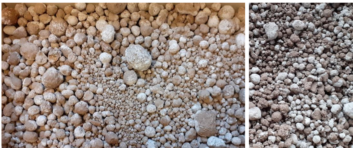
Rysunek 6. Kruszywo otrzymane po procesie stabilizacji
