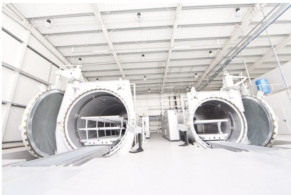
Rysunek 25. Autoklawy Śląskiego Centrum Naukowo-Technologicznego Przemysłu Lotniczego [22]
