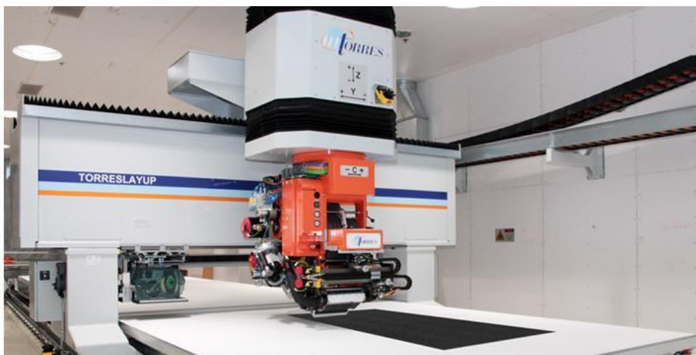
Rysunek 34. Ploter do automatycznego układania prepregów [48]
