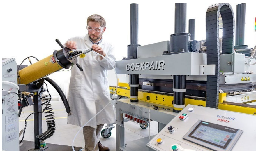
Zdjęcie 3: Próba automatyzacji technologii produkcji kompozytów metodą RTM w firmie Coexpair SA [źródło: https://cordis.europa.eu/docs/results/images/2020-07/421714.jpg ]
