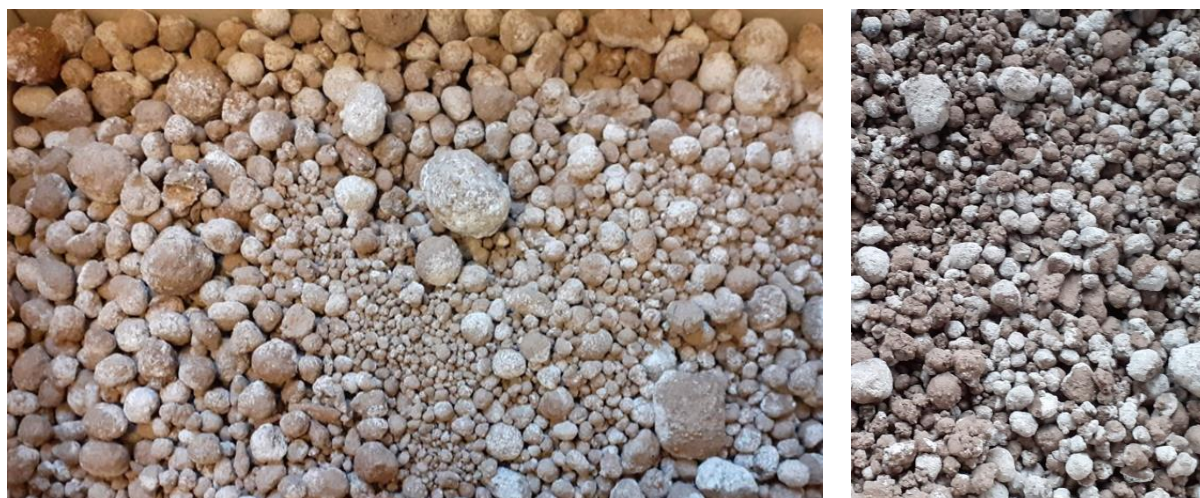
Rysunek 5. Kruszywo otrzymane po procesie stabilizacji
